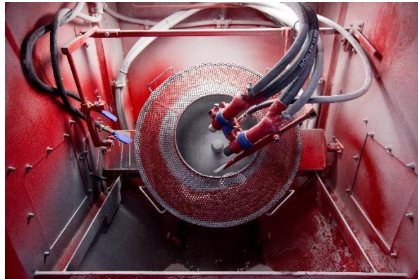
Il.21: Automatyczna śrutownica z powietrzem
