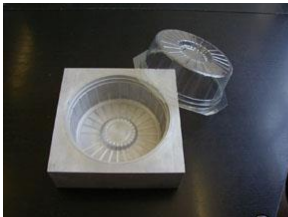
Il. 14: Porowata forma aluminiowa z Metapor® CMMaterials
