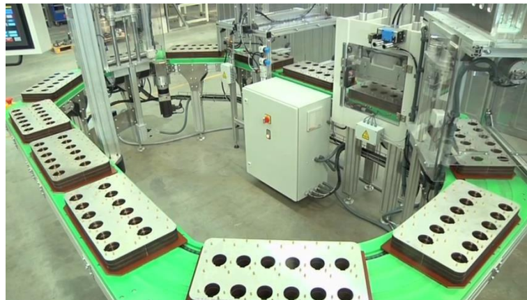
Il.17: Karuzela uszczelniająca blistry Hamer, więcej informacji na: https://www.youtube.com/watch?v=B8zKdT9WZQ
