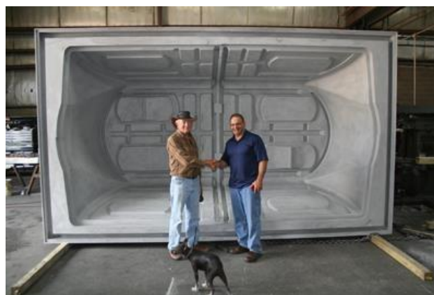
Il. 12: Forma odlewu aluminiowego dla dużego przekroju
