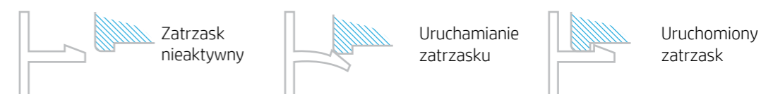
Il. 2: Obsługa zatrzasków podczas montażu
