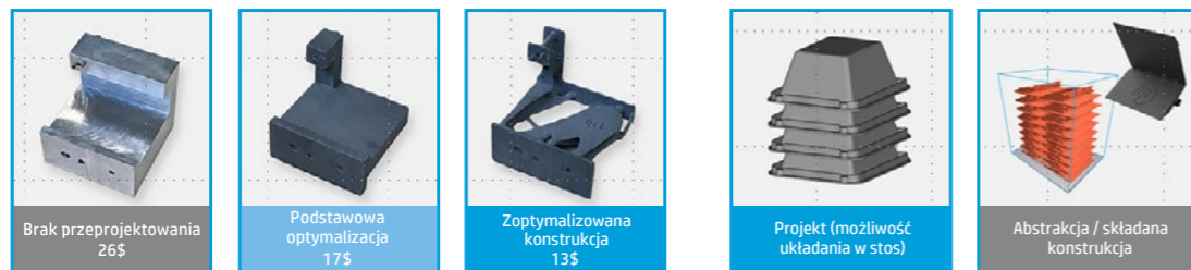
Il. 12: Zoptymalizowane zużycie materiału
